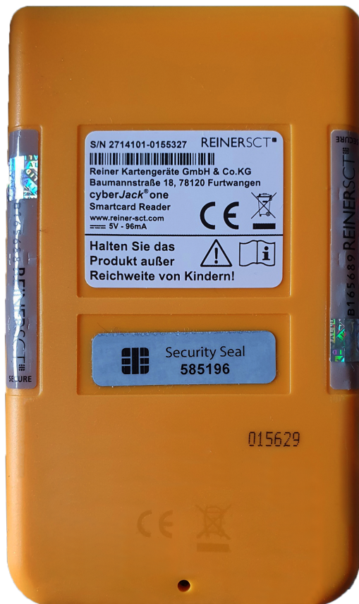
4) Korrekte Siegelung am Gerät
